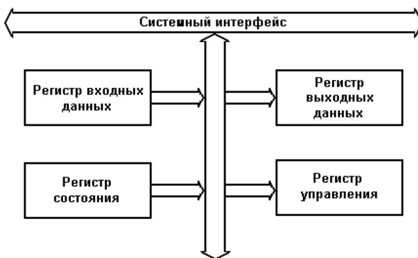
Рис. 28. Программная модель внешнего устройства
