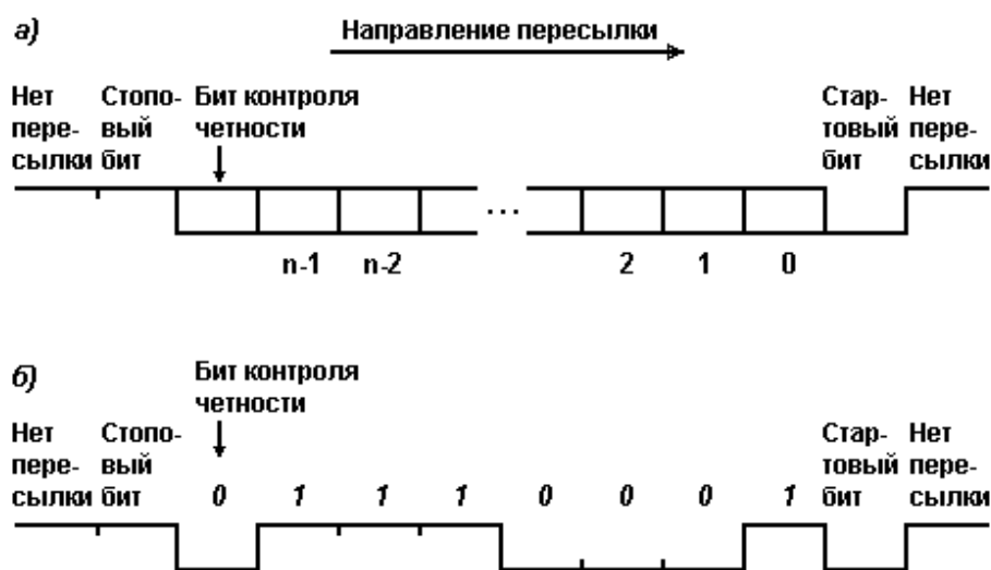
Рис. 30. Формат асинхронной последовательной передачи данных
